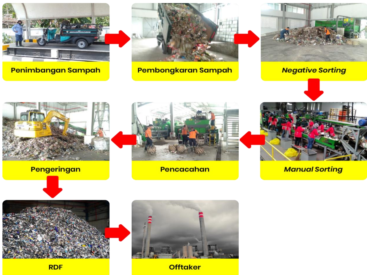
Gambar 2.7 Alur Pengolahan Sampah Menjadi Refuse-Derived Fuel
